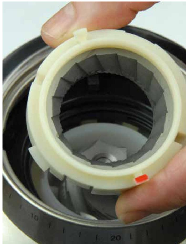
ring so weit wie möglich gegen Uhrzeigersinn gedreht ist. Setzen Sie die roten Noppen der Mahlscheibe auf die rechteckige Aussparung des schwarzen Stellrings. Wackeln Sie an dem Mahlscheiben-Ring und drücken ihn fest nach unten. Stellen Sie sicher, dass er richtig sitzt. Nach dem Einsetzen der Mahlscheibe, setzen Sie die Silikonichtung mit den beiden roten Noppen auf die kleinen Noppen des Mahlscheiben-Rings und schieben die Silikonichtung auf den Mahlscheiben-Ring.
